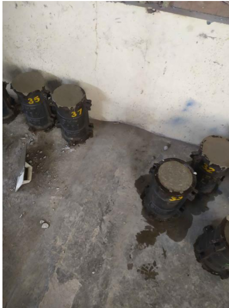
Gambar L-6.3 Pencetakan Benda Uji Silinder
