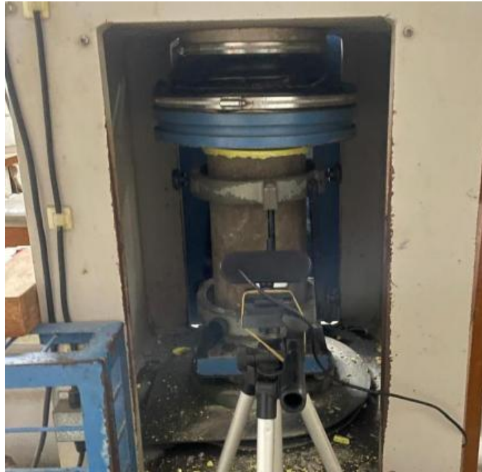
Gambar L-6.7 Pengujian Kuat Tekan dan Modulus Elastisitas Beton
