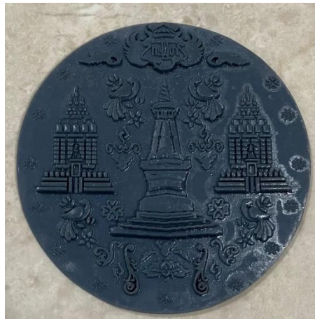
Gambar 4.4 Hasil pembuatan master menggunakan resin standar
