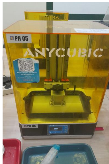
Gambar 3.3 Proses Pencetakan Master
