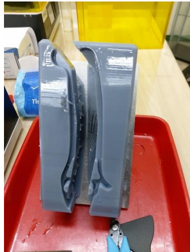
Gambar 4-38 Cavity dengan Penyangga
