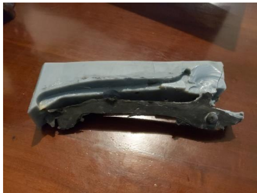
Gambar 4-48 Produk Terlepas dari Cetakan
