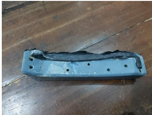
Gambar 4-44 Produk Menempel pada Satu Bagian Cavity
