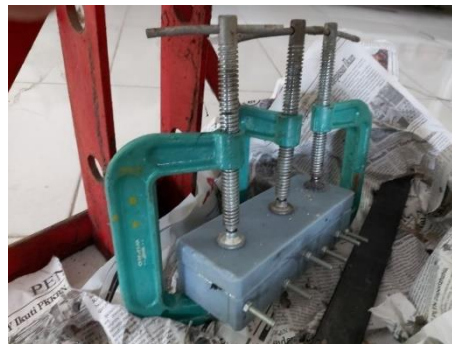
Gambar 4-41 Penekanan Produk dengan Klem C
