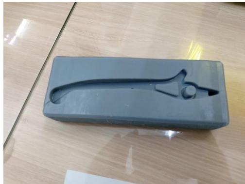
Gambar 4-40 Cavity dalam Bentuk Tersambung Setelah Proses Curing
