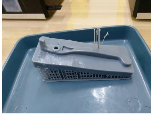
Gambar 4-37 Core Sebelum Penyangga Dilepas
