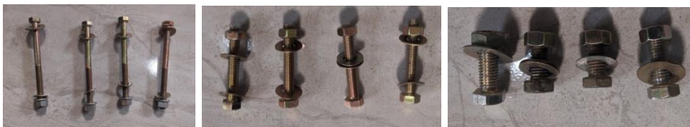
Gambar 3-26 baut,ring dan mur ukuran 12 panjang 10 cm, 5 cm 3 cm
