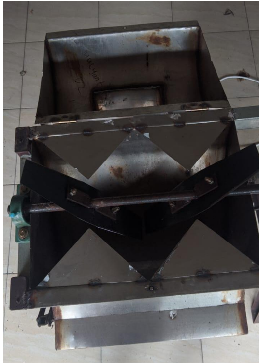
Gambar 4.21 Hasil penambahan plat disekitar pisau
