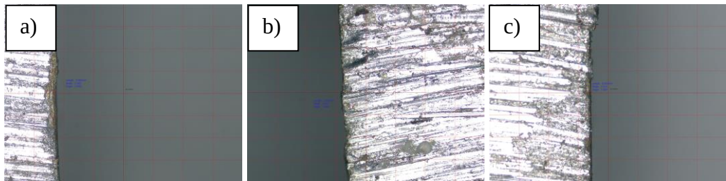
Gambar 4- 41 Hasil Pengamatan Struktur Makro Ketebalan Hasil Anodize Variasi Lama Waktu Pewarnaan 20 Menit
