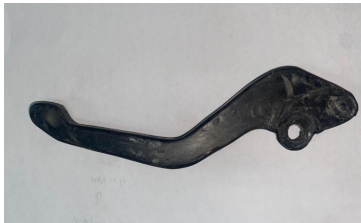
Gambar 4-3 Produk Handel Rem Panjang Serat Karbon 5cm
