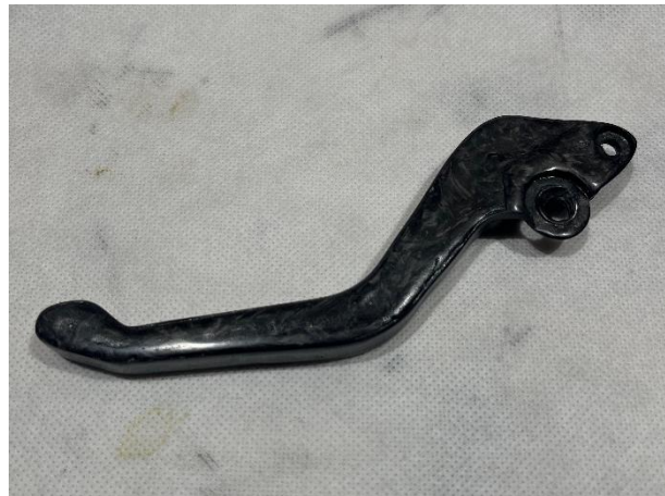
Gambar 4-1 Produk Handel Rem Panjang Serat Karbon 10 mm
