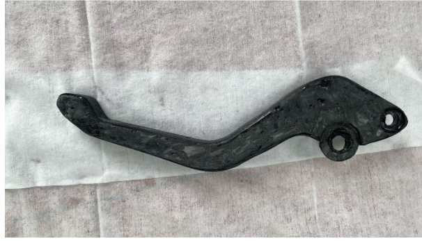
Gambar 4-2 Produk Handel Rem Panjang Serat Karbon 30 mm
