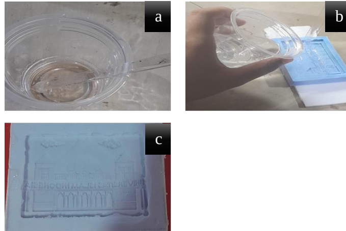
Gambar 3. 8 Proses Cetak Resin dimulai a) Pencampuran resin dengan Hardener, b) Penuangan Resin, dan c) Pengeringan Produk
