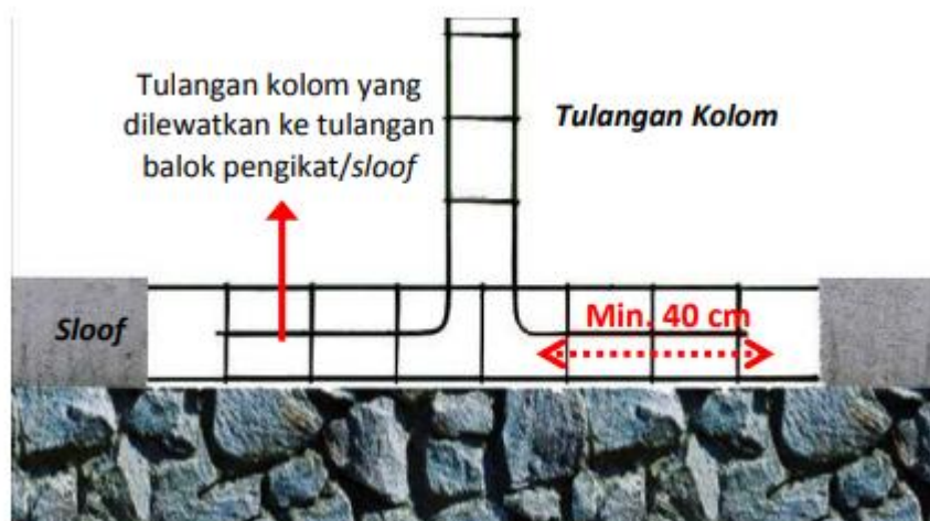
Gambar 3. 13 Angkur Hubungan Kolom-Sloof
