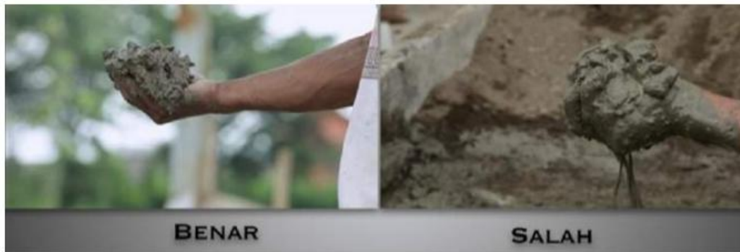
Gambar 3. 6 Melakukan Pengujian hasil pencampuran beton secara manual
