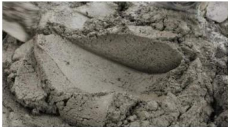
Gambar 3. 8 Hasil Pencampuran Mortar yang Sesuai Syarat Pokok
