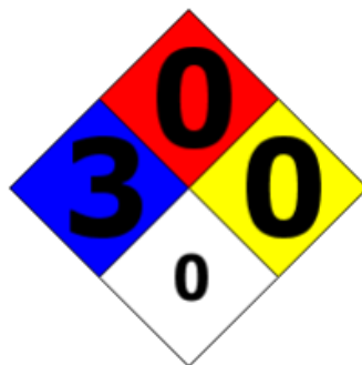
Gambar 2. 3 Hazard Diamond pada Sodium Silikat
