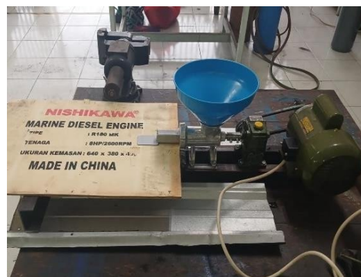
Gambar 4. 7 Hasil perakitan alat pencetak briket
