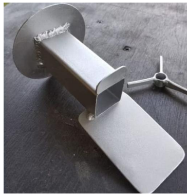
Gambar 4. 5 Hasil pembuatan cetakan
