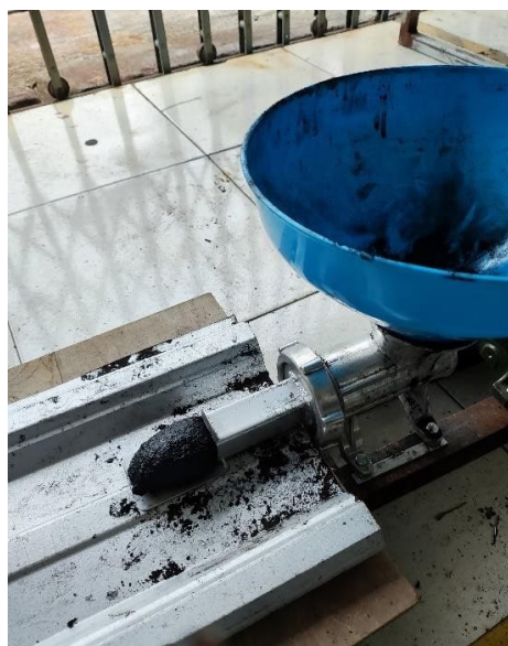
Gambar 4. 9 Campuran briket keluar dari cetakan
