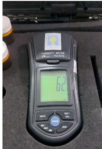
Gambar 3.9 Pengecekan kekeruhan awal air limbah industri batik
