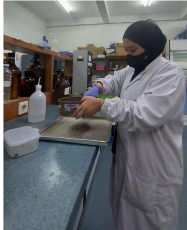
Gambar 3. 6 Proses pengayakan serbuk biji bijian menggunakan ayakan 70 dan 100 mesh.
