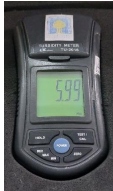
Gambar 3.11 Pengecekan kekeruhan pemberian koagulan kimia
