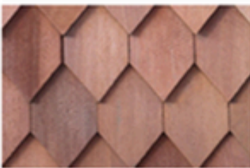
Material atap menggunakan sirap Ulin
