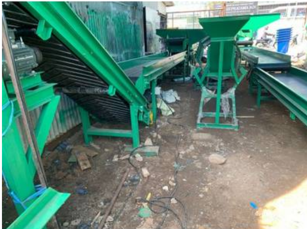
Gambar 2.3.2. Mesin Conveyor Pemilah Sampah CPS 6012 Sumber : Kencana Online
