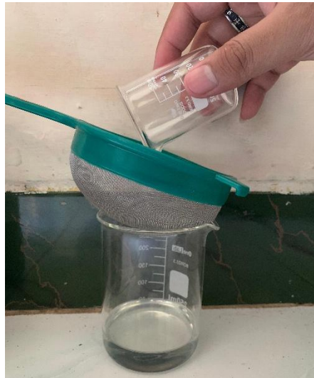
Gambar 3-11 Penyaringan Campuran Resin
