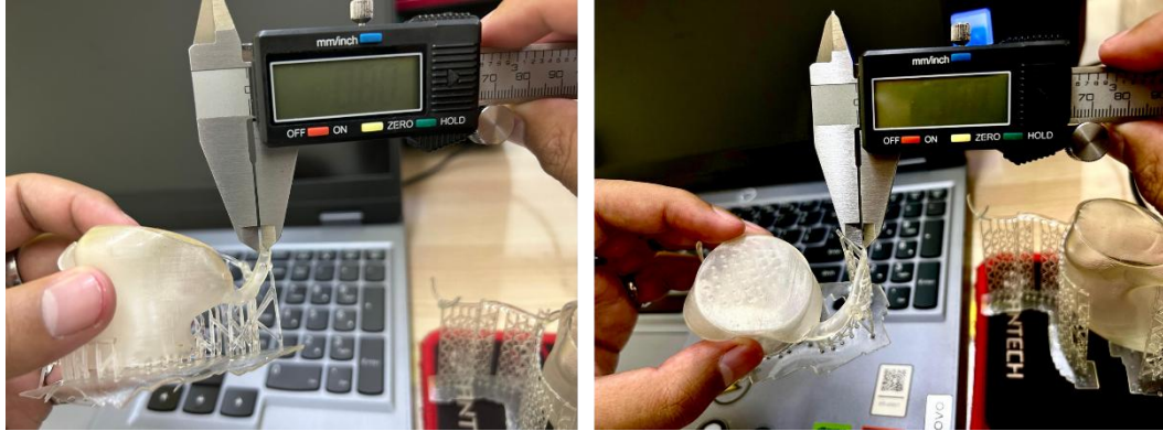
Gambar 3-17 Pengujian Ketebalan Dinding Arteri Koroner pada Model
