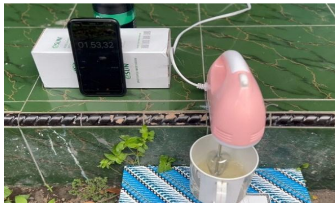
Gambar 3-10 Pengadukan Campuran Resin Menggunakan Mixer
