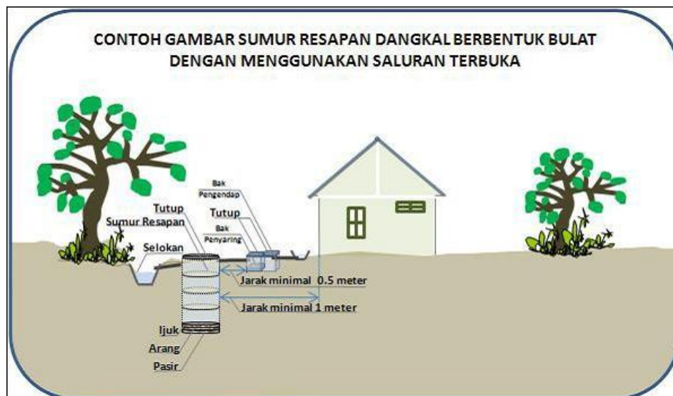
Gambar 4.5 Contoh Saluran Sumur Resapan
