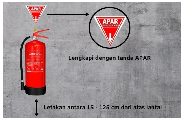
Gambar 5.3 Contoh Penempatan APAR
