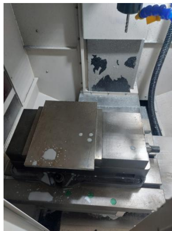
Gambar 3-18 mencekam benda kerja pada ragum mesin CNC
