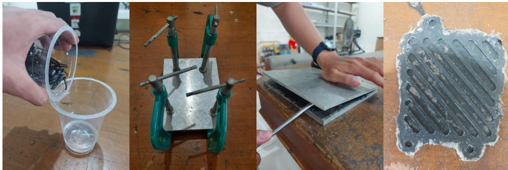
Gambar 4-6 Proses pencetakan produk komposit dengan chopped carbon fiber
