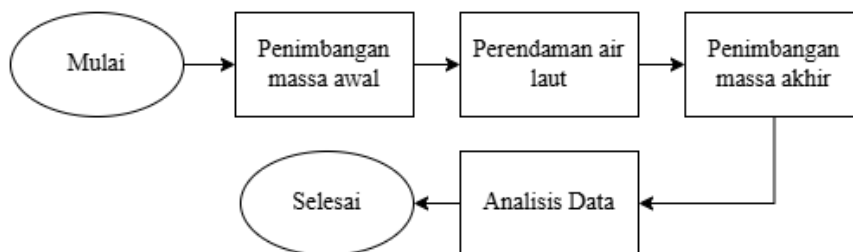
Gambar 3 - 19 Alur Pengujian Laju Korosi
