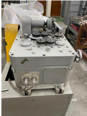
Gambar 3 - 17 Proses Pengujian Keausan
