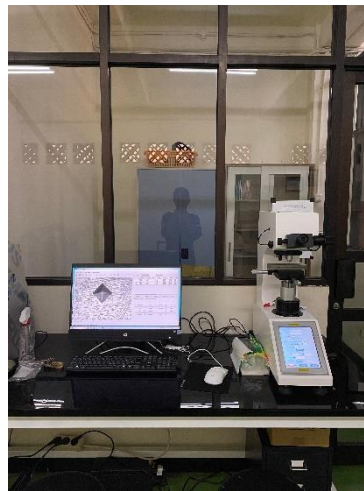
Gambar 3 - 13 Proses Pengujian Kekerasan Vickers
