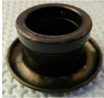
Gambar 4-9 Hasil cetak corong pendek
