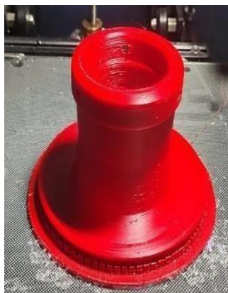
Gambar 4-8 Hasil cetak corong panjang
