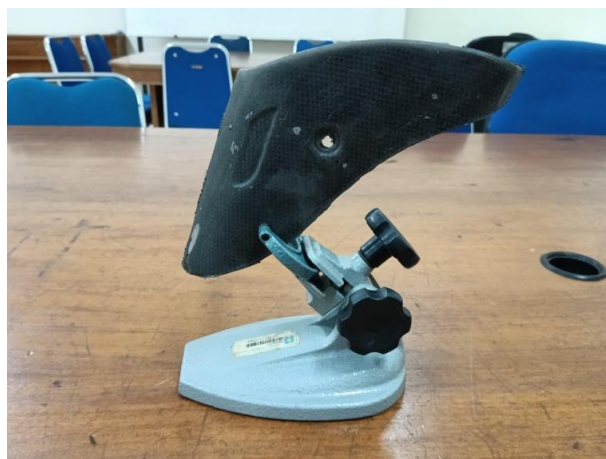
Gambar 3.17 Pengukuran ketebalan di titik C
