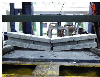
Gambar 5.27 Kerusakan Pada Pengujian Pembebanan Tegak Lurus Bidang Dinding ( out of plane )
