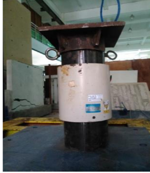
Gambar 4.6 Load Cell (Sumber: Hidayah, 2016)
