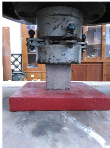
Gambar 4.20 Uji Tekan Mortar
