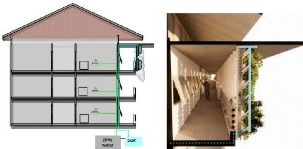
Gambar 8 Potongan Bangunan yang Menunjukkan Sistem Pengairan Sumber: Hasil Analisis Penulis
