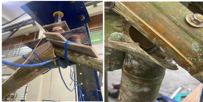
Gambar 9 , Batang bambu pecah pada sambungan
