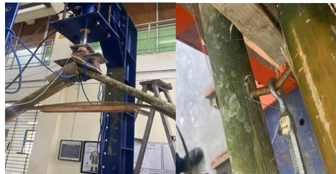
Gambar 10 , Batang lengkung menjadi lurus dan baut penahan kabel menjadi bengkok.
