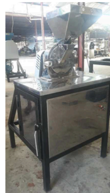
Gambar 48. Mesin Coffee Grinder Kapasitas 15 Kg/Jam Sumber: Pusat Penelitian Kopi & Kakao Indonesia
