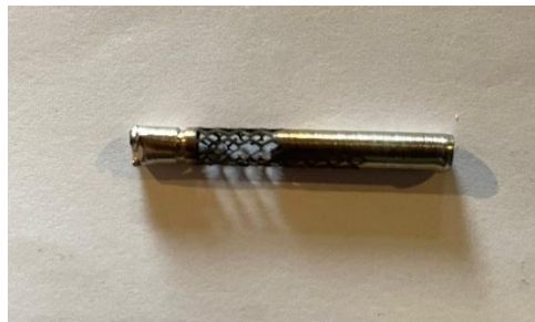
Gambar 4. 4 Kegagalan pada struktur stent
