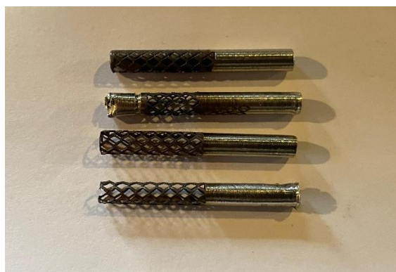
Gambar 4. 2 Hasil model stent menggunakan laser marking
