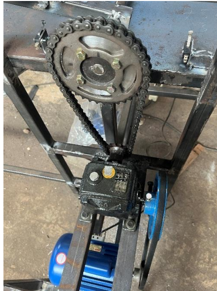
Gambar 3. 26 Pemasangan Motor, Puli, Sabuk, Gearbox dan Rantai Penggerak Tuas
