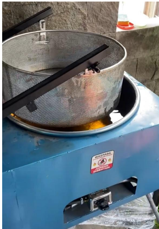
Gambar 3. 29 Memasang Keranjang pada Tuas
