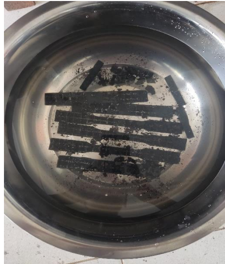
Gambar 3-14 Quenching Menggunakan Air
