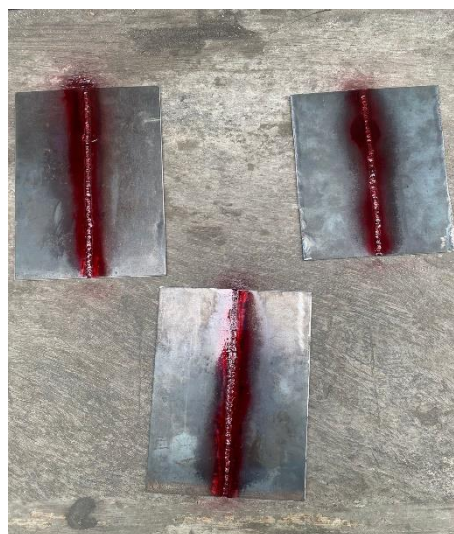
Gambar 3-5 Pemberian Penetrant pada Pelat Hasil Pengelasan
