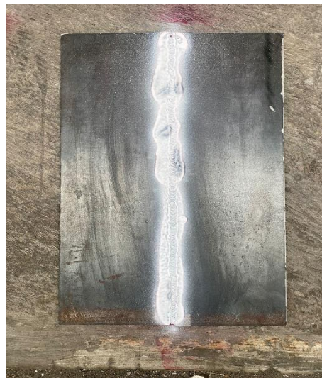
Gambar 3-6 Pemberian Developer pada Pelat Hasil Pengelasan
