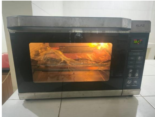
Gambar 3- 14 Proses Curing Spesimen
