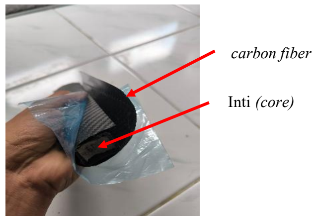
Gambar 3- 12 Pelapisan Fiber Karbon pada Core
