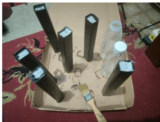
Gambar 3- 15 Proses Finishing Spesimen Uji
