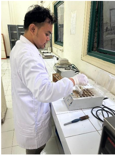
Pengujian COD memasukkan tabung refluks ke dalam termoreaktor
