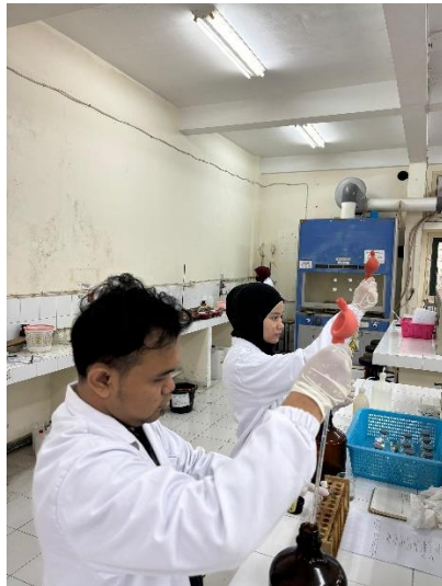
Pengujian COD memasukkan sampel ke dalam tabung refluks
