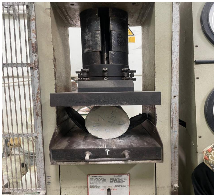
Gambar L-7. 8 Pengujian Kuat Tarik Belah Beton
