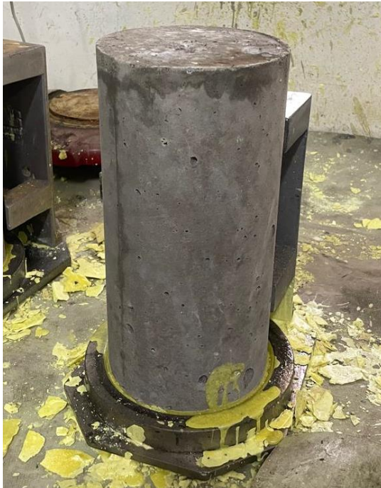
Gambar L-7. 5 Capping Benda Uji Silinder
