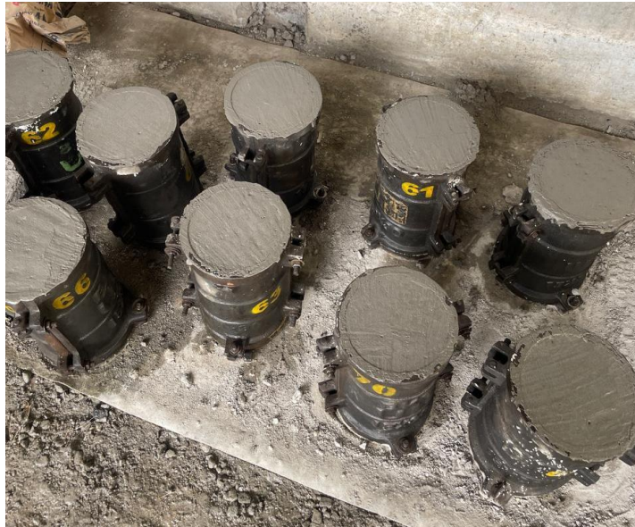
Gambar L-7. 3 Pencetakan Benda Uji Silinder
