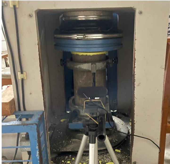
Gambar L-7. 7 Pengujian Kuat tekan dan Modulus Elastisitas Beton
