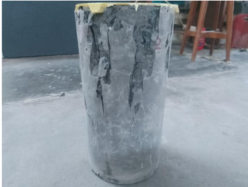
Gambar L-5. 5 Kerusakan Benda Uji Setelah Pengujian
