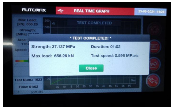
Gambar 5. 35 Hasil Pengujian PCC Tinggi 14 Hari Sumber: Penelitian (2024)
