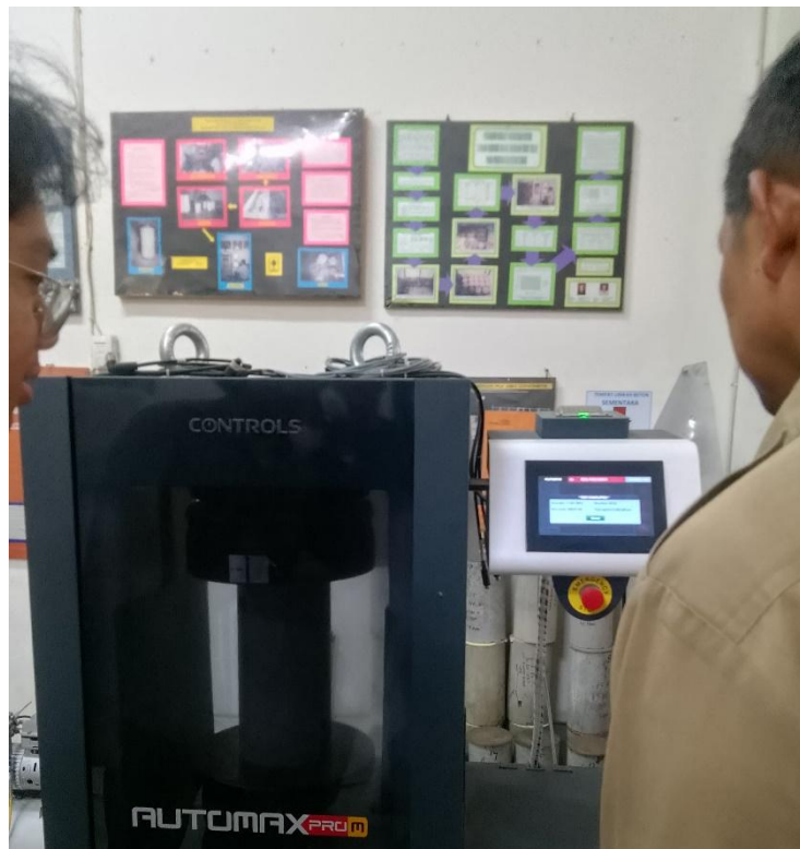
Gambar L-5. 4 Proses Pengujian Kuat Tekan
