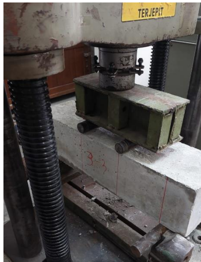
Gambar 5.14 Beban Pengujian Balok
