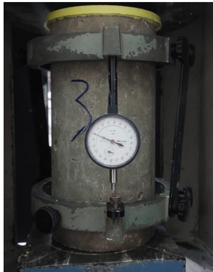
Gambar 5.13 Pengujian Modulus Elastisitas dengan Ekstensiometer dan Mesin Kuat Tekan
