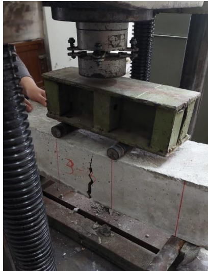
Gambar 5.15 Keruntuhan Balok Setelah Pengujian
