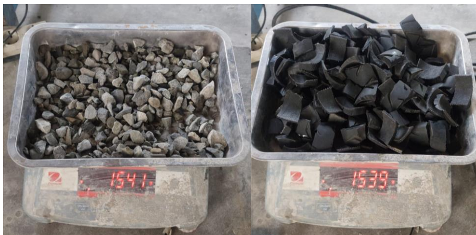
Gambar 5.6 Perbandingan Volume Karet dengan Agregat Kasar
