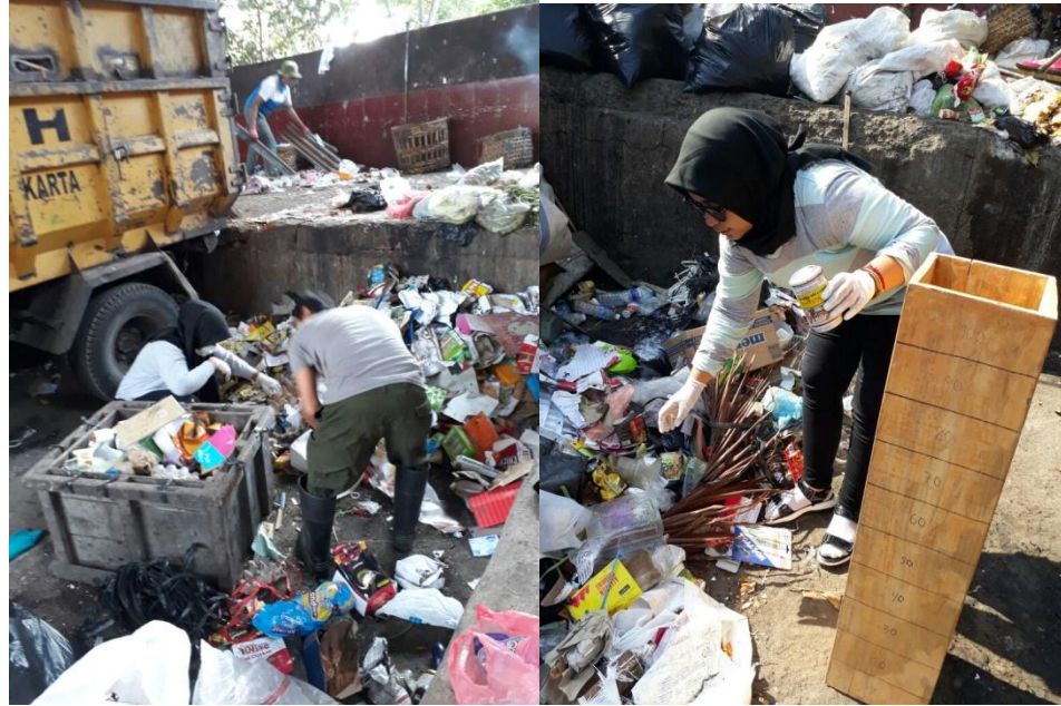
Gambar lampiran 1 uji sampling sampah menggunakan kotak sampling di TPS Purawisata dan TPS Mandala Krida
