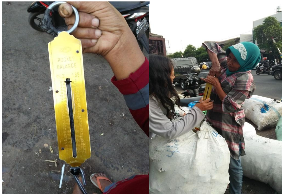
Gambar lampiran 2 uji sampling sampah dengan cara menimbang di TPS Purawisata
