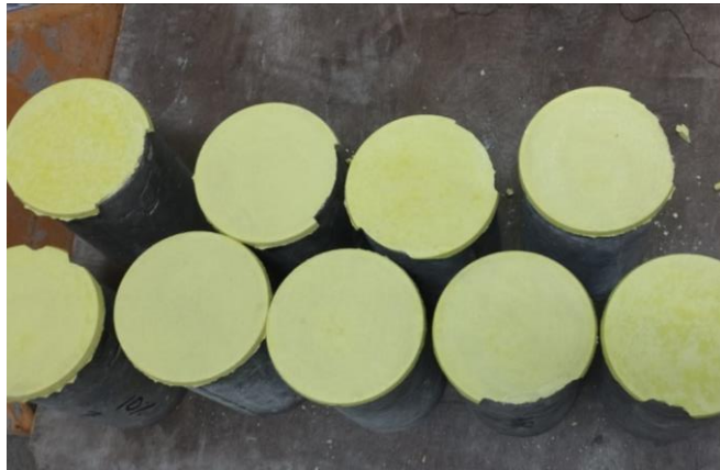
Gambar L-2.10 Benda Uji untuk Pengujian Tekan Beton
