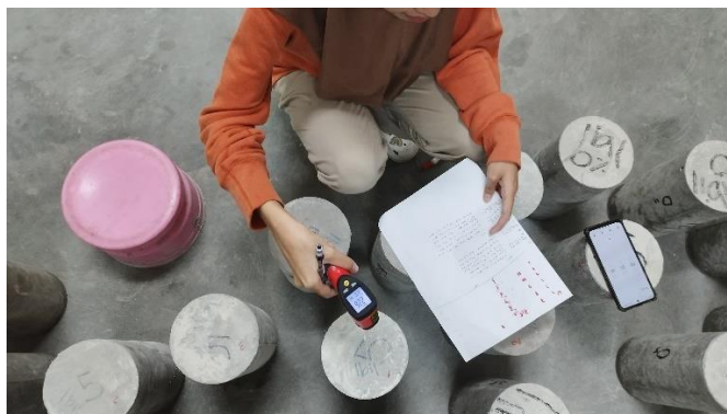
Gambar L-2.10 Pengukuran Suhu Permukaan Beton
