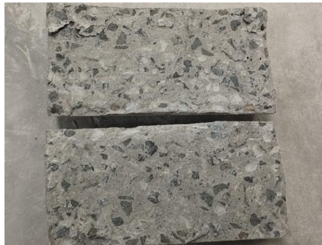
Gambar 5.13 Hasil Pengujian Kuat Tarik Beton dengan Paraffin
