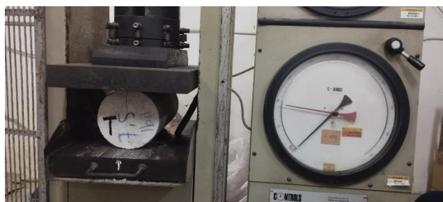
Gambar L-2.9 Mesin Uji Tarik Belah Beton
