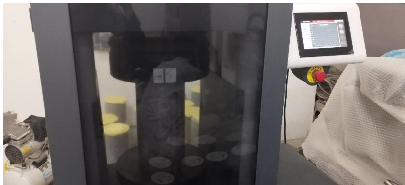
Gambar 5.11 Contoh Pengujian Kuat Tekan Beton
