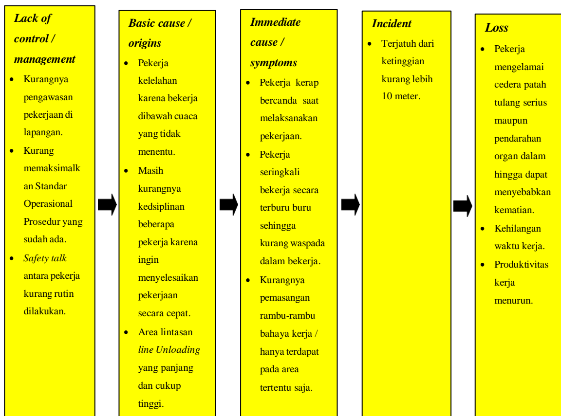
Gambar 4. 6 Diagram Domino Pekerjaan Pengecekan Line Unloading dengan Risiko Terjatuh Saat Berjalan Melintasi Line Unloading
