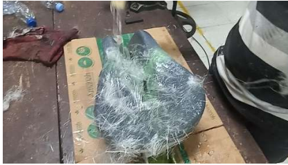
Gambar 4-48 Foto pengaplikasian fiber glass pada master .
