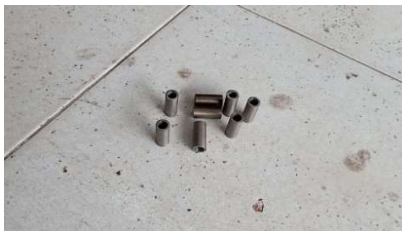
Gambar 4-57 Foto hasil pembubutan bosh .
