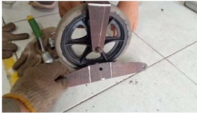
Gambar 4-41 Foto dudukan roda caster sebelum dan sesudah ditebuk.
