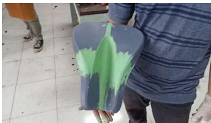
Gambar 4-46 Foto mockup pelana sesudah didempul untuk dijadikan master .
