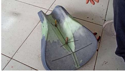
Gambar 4-47 Foto pemberian tulangan untuk dasaran pelana.
