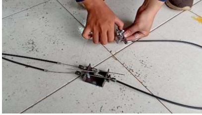
Gambar 4-25 Foto pemasangan kabel rem.
