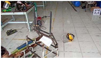
Gambar 4-32 Foto bagian frame sandaran yang sudah terpasang pada kursi roda.
