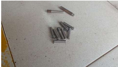
Gambar 4-56 Foto hasil pembubutan pin .
