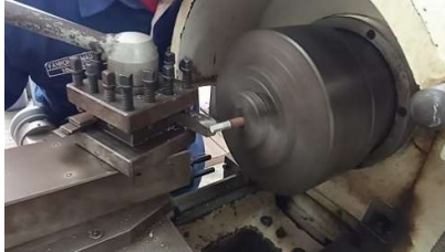
Gambar 4-55 Foto proses bubut.
