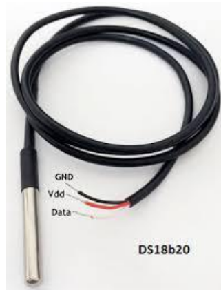
Gambar 2.1 Sensor Suhu DS18B20 Sumber : (Rasid & Mazuki, 2017)
