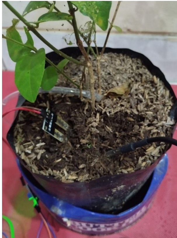
Gambar 4.14 Pengujian sensor DS18B20 Sumber: Dokumentasi pribadi
