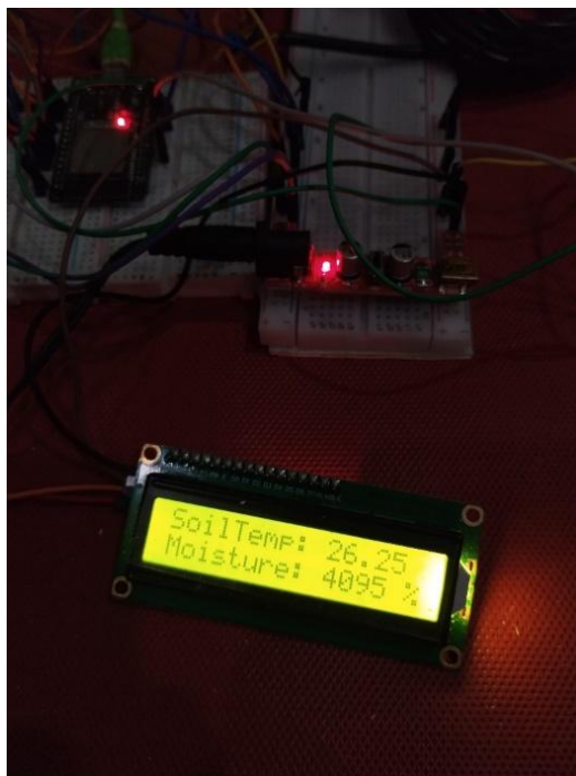
Gambar 4.17 Pengujian LCD 16X2 I2C Sumber: Dokumentasi pribadi
