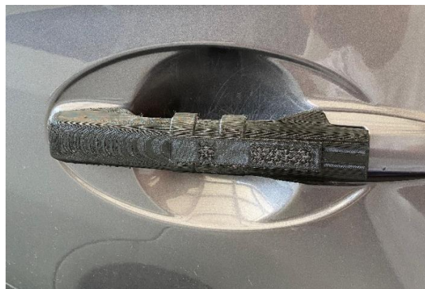
Gambar 4. 21 Pemasangan Material PETG
