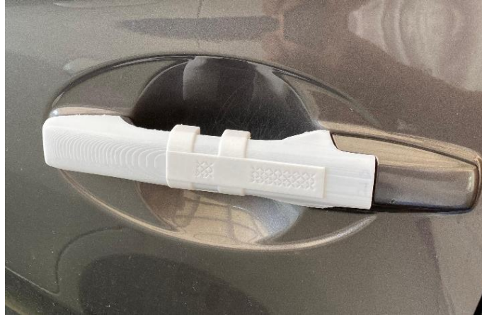
Gambar 4. 22 Pemasangan Material PLA+
