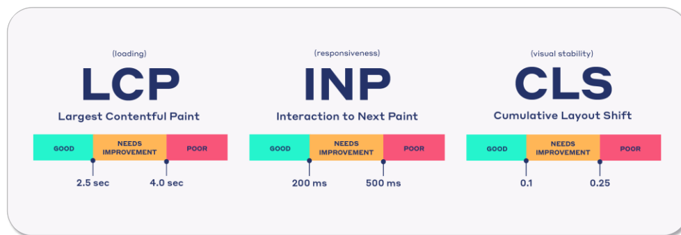
Gambar 2.3 Metrik Chrome DevTools Performance Tab dengan kode warna berdasarkan ambang performa
