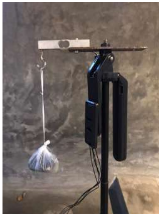
Gambar 4. 3 Batu Kalibrasi Digantungkan Pada Load Cell
