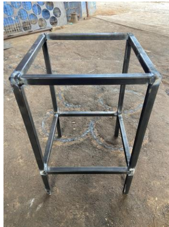
Gambar 3.9 Hasil Rangka Alat Penggiling
