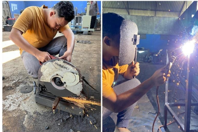
Gambar 3.8 Proses Pembuatan Rangka
