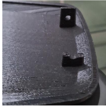
Gambar 4. 34 Bagian yang mengalami gagal (patah)
