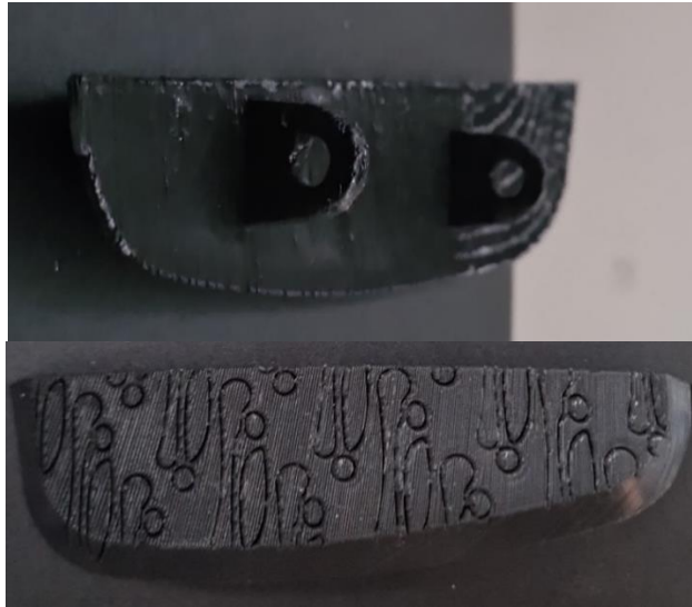
Gambar 4. 27 Hasil printing bagian dudukan baut ( cutting )
