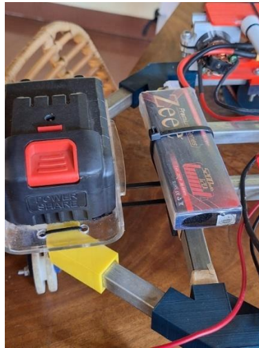
Gambar 4.7 Penempatan Baterai Li-Po dan Baterai Li-Ion
