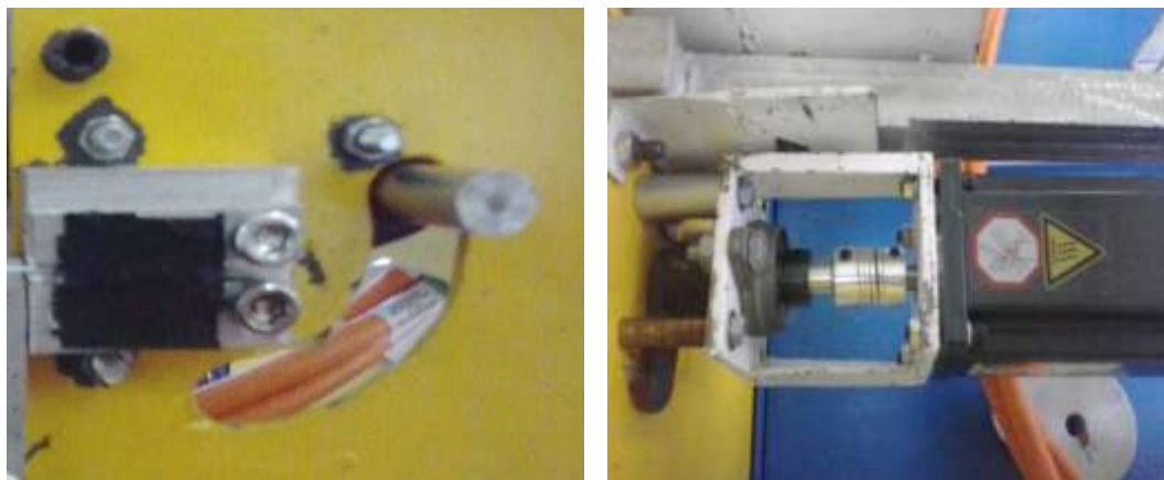
Gambar 4. 14 Hasil Perancangan Proses Penekuk pada Mesin CNC pembuat Begel
