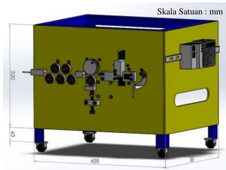
Gambar 4. 1 Hasil Perancangan Mesin CNC Pembuat Cincin Begel
