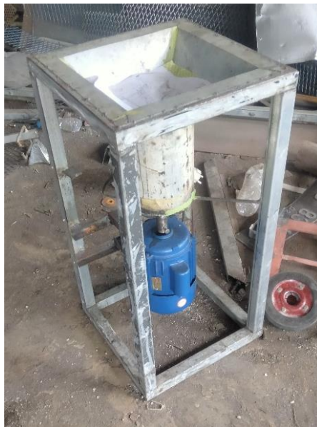
Gambar 3-9 Pembuatan Frame dan Tabung
