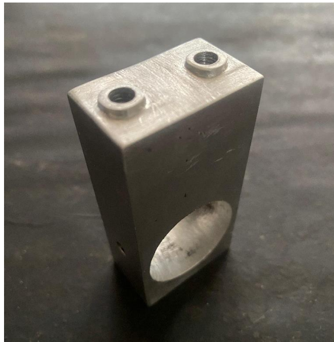
Gambar 4-34 Hasil Pemesinan CNC Bagian 2
