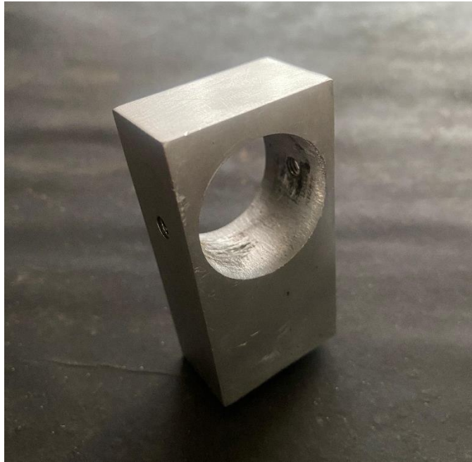
Gambar 4-33 Hasil Pemesinan CNC Bagian 1
