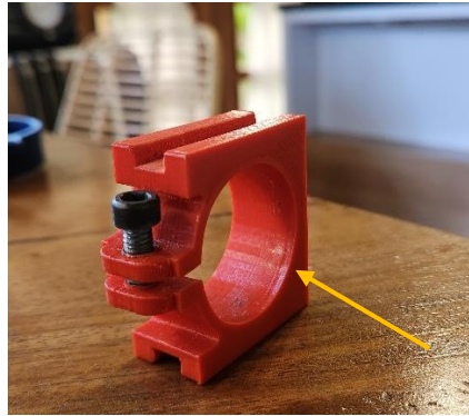
Gambar 4.35 Braket Housing Dinamo Penggerak Utama Mengalami Deformasi
