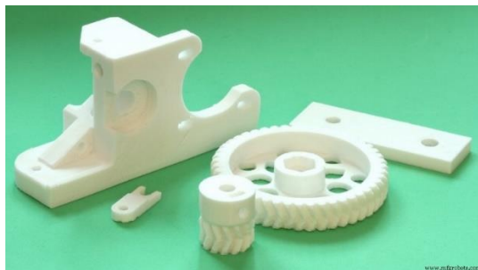
Gambar 4.1 Contoh hasil pemesinan 3D printing
