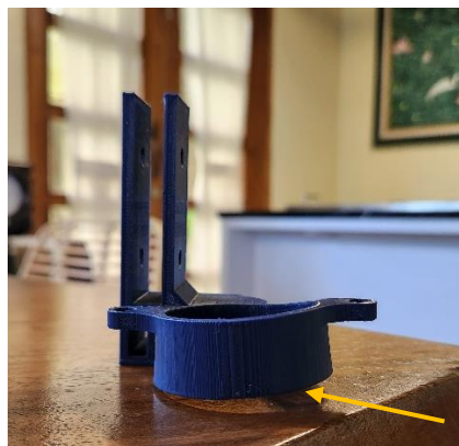
Gambar 4.34 Braket Housing Dinamo Mata Pemotong Mengalami Deformasi
