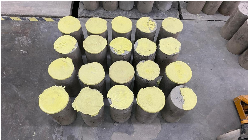
Gambar L-8.5 Benda Uji Beton RHA + WSA Setelah Pengujian
