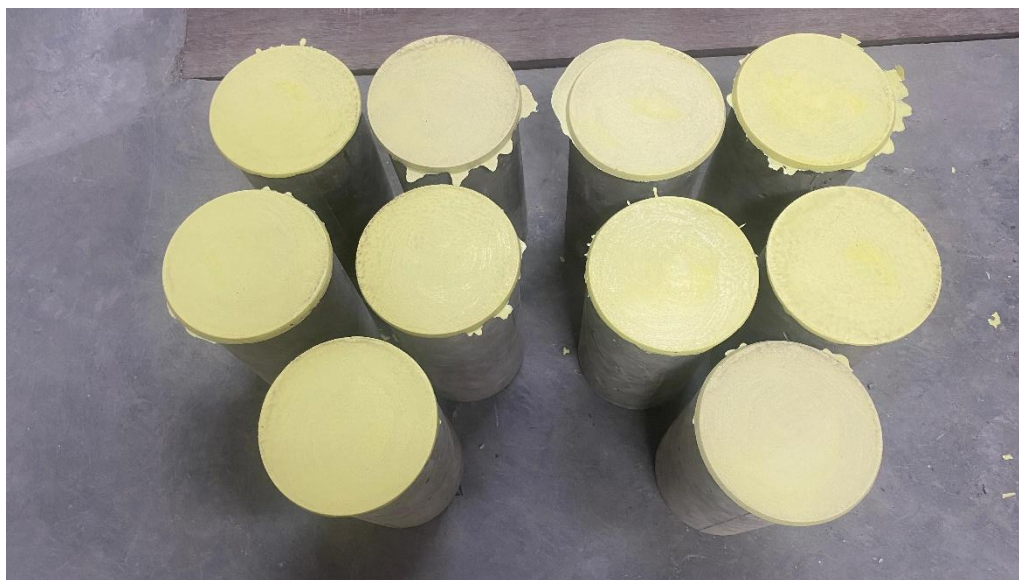
Gambar L-8.2 Benda Uji Beton Normal Sebelum Pengujian
