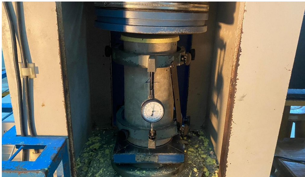
Gambar L-8.1 Mesin Uji Tekan dan Dial Gauge
