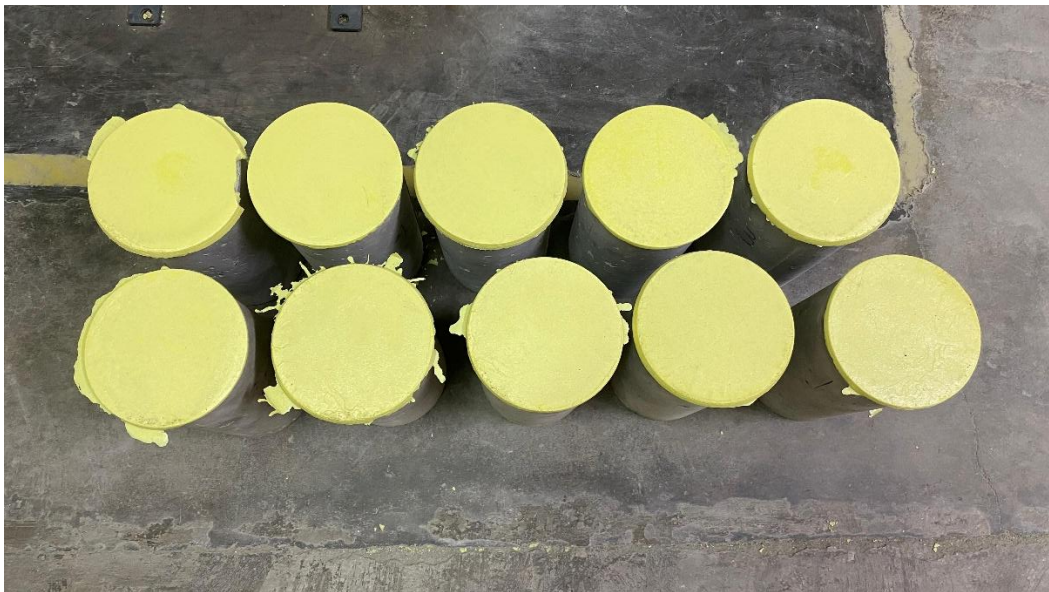
Gambar L-8.4 Benda Uji Beton RHA + WSA Sebelum Pengujian
