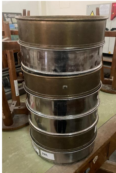
Gambar L-7.1 Set Saringan Agregat
