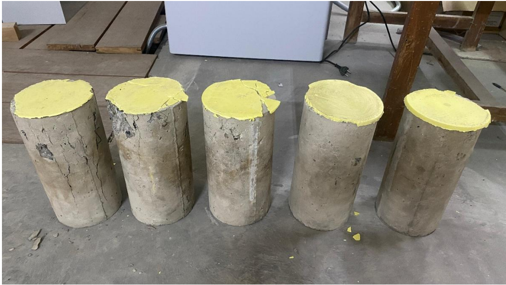
Gambar L-8.3 Benda Uji Beton Normal Setelah Pengujian
