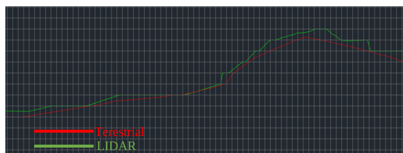
Gambar 5. 7 Profil Perbandingan LIDAR dan terrestrial
