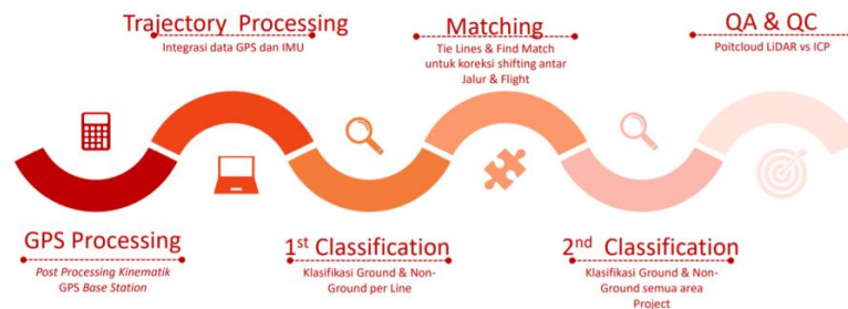
Gambar 3. 6 Alur Pekerjaan Pengolahan Data LIDAR
