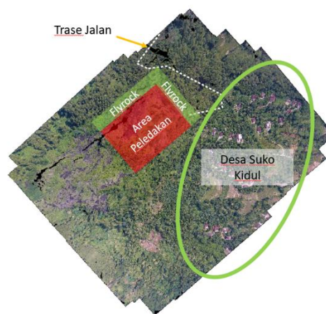
Gambar 2. 3 Lokasi trase hauling setelah re-design dengan menggunakan data DTM hasil survey fotogrametri dengan UAV (Oliver et al, 2022)
